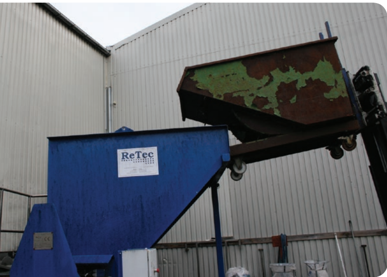
PET Flaschen werden in den Aufgabetrichter gefüllt.
