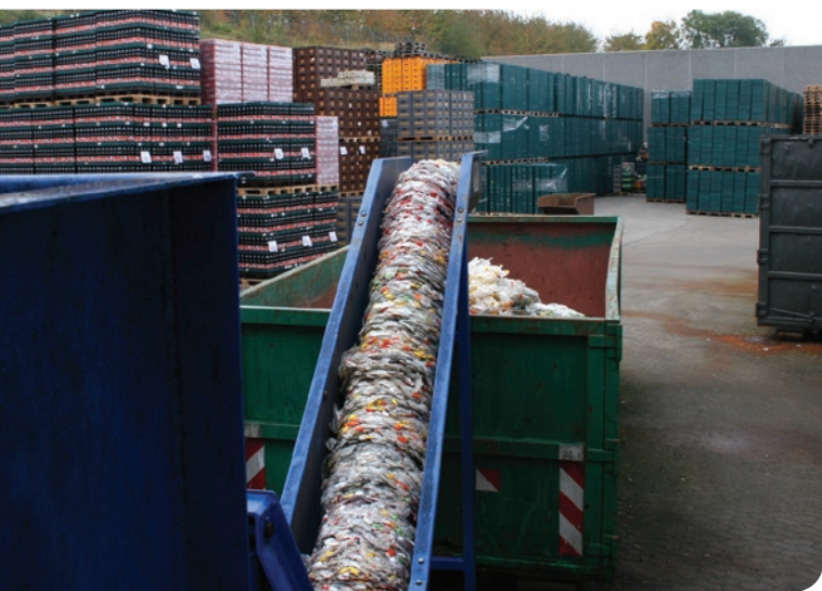
Entleerte und gepresste PET Flaschen nach der Presse.
