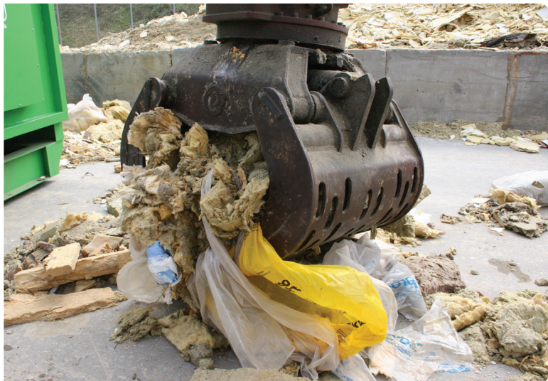
Eingangsmaterial, eine Mischung von Verpackung, Steinwolle, Glaswolle, Schaum, Gummi, Nägeln, Schrauben, Holz und vielem mehr. In der endgültigen Feinfraktion werden nur Mineralwolle und Material freigesetzt, die kleiner als die Größe Lochsiebung sind.
