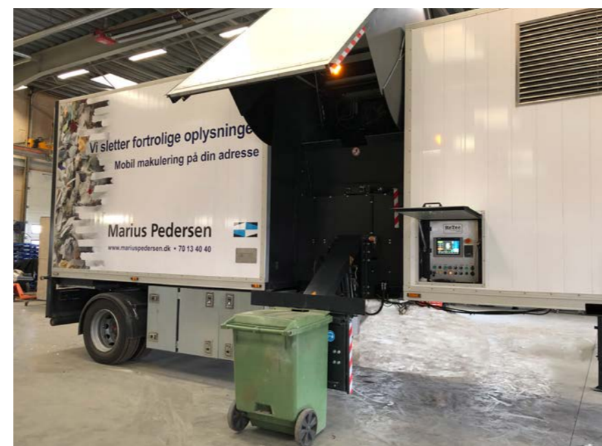
Das TÜV / Force genehmigtes Behälterliftsystem kann für verschiedene Größen & Arten angepasst werden.
