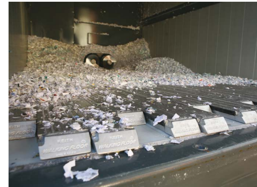
Entladung nach hinten durch Schubboden.
