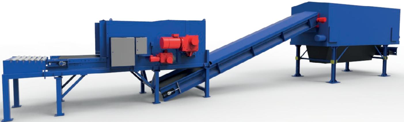
ReTec SRF Ballenöffnungssystem mit einer Durchsatzleistung von 40 Tonnen pro Stunde
